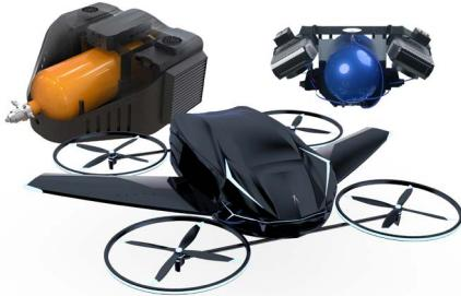
호그린에어의 수소파워팩은 기존의 배터리드론 문제점을 보완하여, PEMFC 연료전지와 기체수소, 액체수소를 사용하여 하나의 시스템으로 설계되어 다양한 수소모빌리티 산업군에 사용이 가능합니다.
