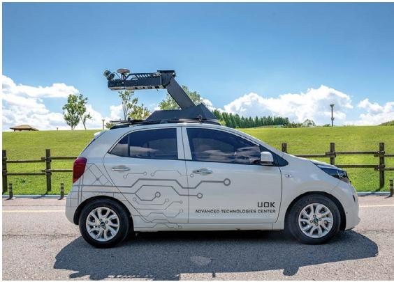
자체 개발한 MMS 장비로서 기존 거리뷰 시스템과 MMS를 선택적으로 활용할 수 있는 하이브리드 장비
