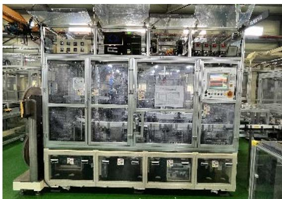
원통형 2차전지 Cell에 Tube 및 Washer를 삽입 후 히터로 수축시키는 장비
