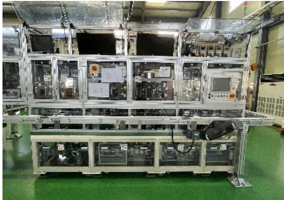
원통형 2차전지 Cell 제조공정 중 Cap을 상면에 고정하는 공정에 사용되는 설비
