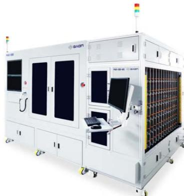
이 시스템은 PCB 스캔 이미지를 분석하여 자동으로 PCB 맵을 생성하며 레이저 마커를 사용하여 PCB의 상단과 하단에 스트립 ID의 2D 바코드를 표시하는 설비
