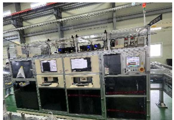
원통형 2차전지 Cell 상면·하면·측면 등의 외형에 이물 및 스크래치를 검사하는 설비
